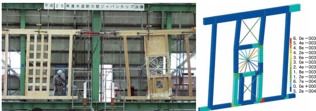
写真7 平成28年度木造耐力壁ジャパンカップ決勝と構造解析結果
